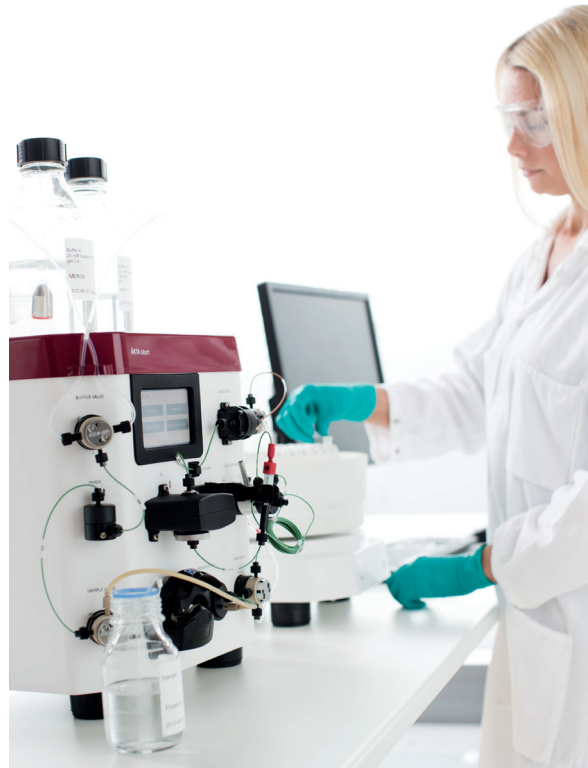
图 1. ÄKTA start 是一款为提高自动化程度而设计的易用型制备型层析系统
