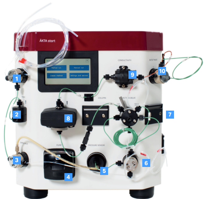
图 2. ÄKTA start 解决方案包括带触摸显示屏的独立仪器、Frac30 组分收集器和用户友好的 UNICORN start 控制软件
